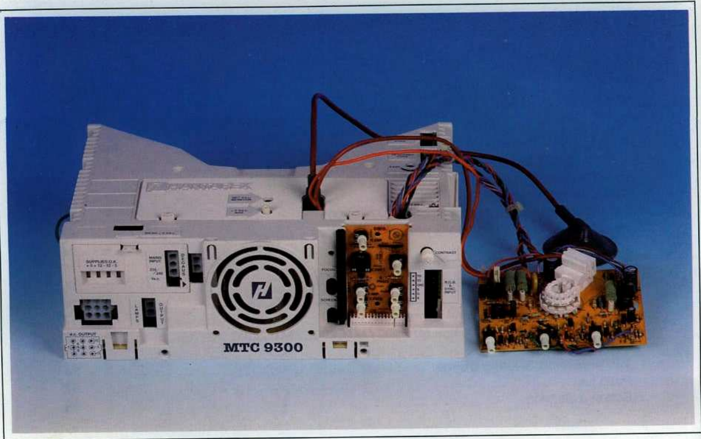
Assieme elettronica / Electronic assembly, cod. / part 63200640 Assieme protezione plastica / Plastic protection assembly, cod. / part 62012750
